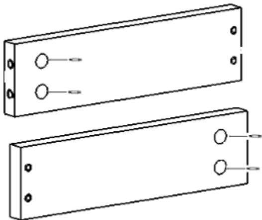
11. С помощью конфирматов соединить детали арт. 20,13,03 и арт. 20,13,06 и арт. 20,13,12
