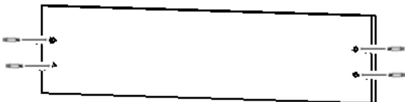
13. Соединить деталь арт. 20,13,11 с конструкцией, закрутить эксцентрики минификсов
