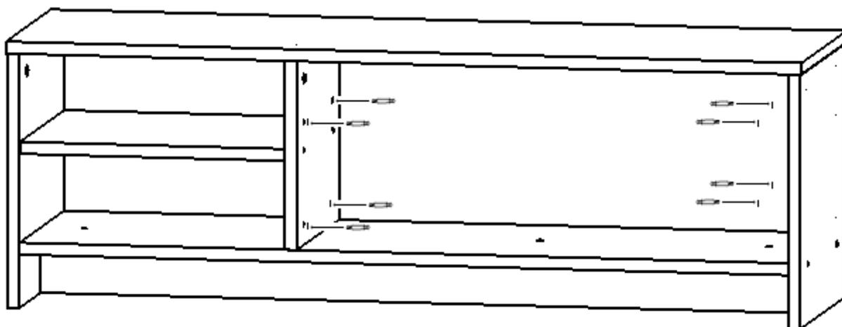
10. В указанные отверстия деталей арт. 20,13,03 и арт. 20,13,06 вставить эксцентрики минификсов
