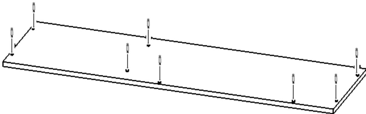
8. Установить деталь арт. 20,13,07, повернуть эксцентрики минификсов
