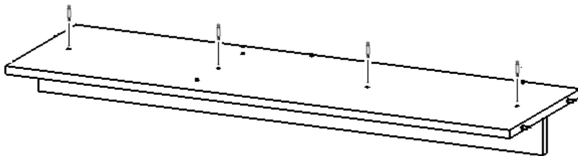
2. В указанные отверстия детали арт. 20,13,09 вставить эксцентрики минификсов
