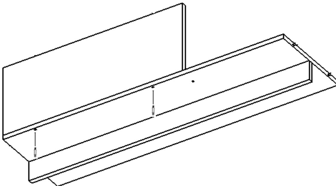
4. В указанные отверстия деталей арт. 20,13,01, арт. 20,13,05, арт. 20,13,04 вставить эксцентрики минификсов
